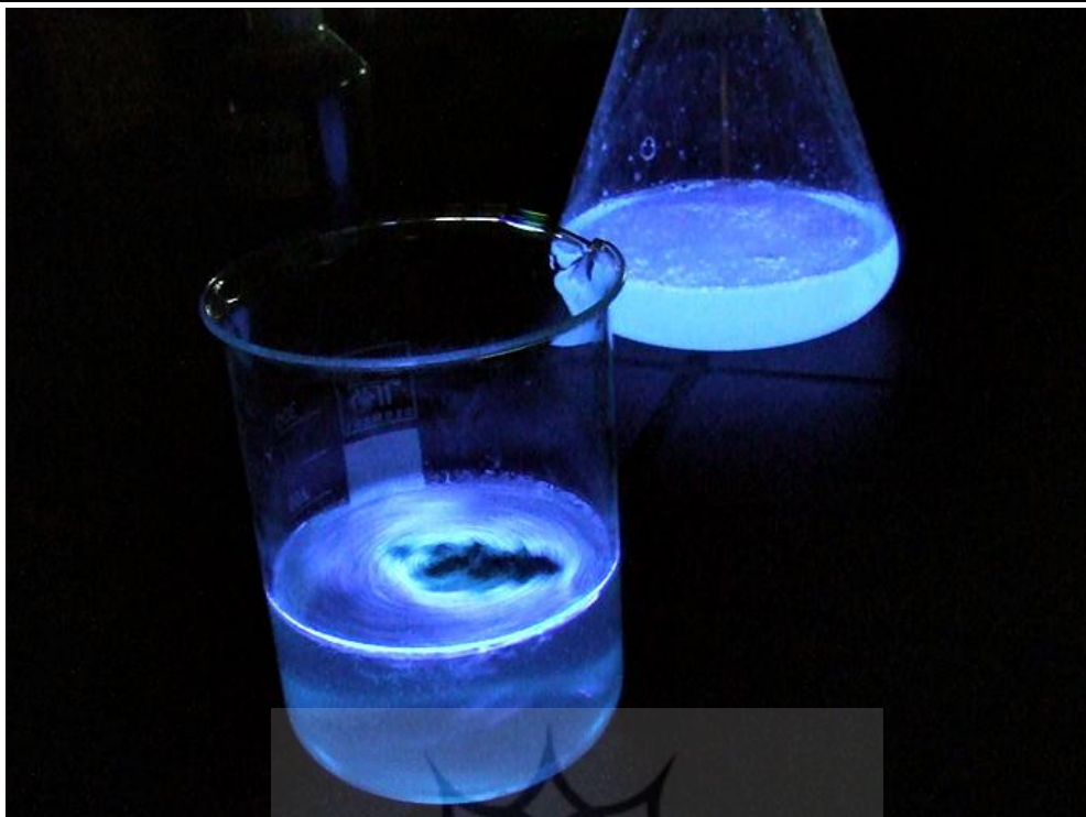
شکل ۱. تابناکی شیمیایی لومینول در محلول قلیایی در حضور آب اکسیژنه و هموگلوبین، که منجر به گسیل نور آبی در اثر واکنش اکسایش می‌شود.
