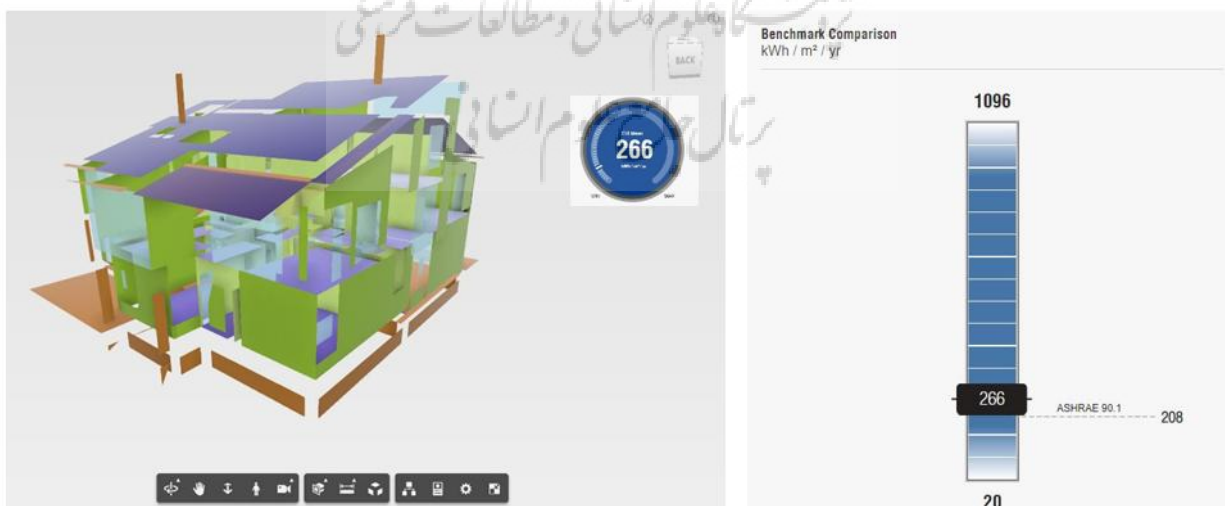
نمودار ۱۰- مدل سه بعدی از ساختمان مدل‌سازی شده توسط پلاگین Insight و وضعیت استاندارد ASHRAE؛ منبع نگارندگان
