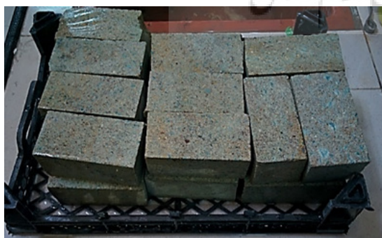
شکل ۳. انتخاب نمونه از معدن سنگ ویر و برش نمونه‌ها در اندازه‌های استاندارد.
