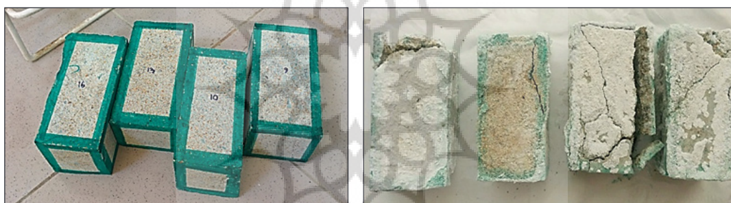
شکل ۷. (راست) نمایش سنگ‌ها در وضعیت سالم و قبل از شروع آزمون مقاومت سنگ‌ها در برابر نمک و (چپ) وضعیت سنگ‌ها پس از طی شدن ۳۵ چرخه.
