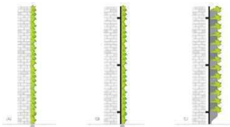
شکل ۳. انواع اصلی دیوار سبز (A): نمای سبز مستقیم، (B): نمای سبز دپوسته، (C): دیوار زنده ماژولار با پانل‌های کشت عمودی.
