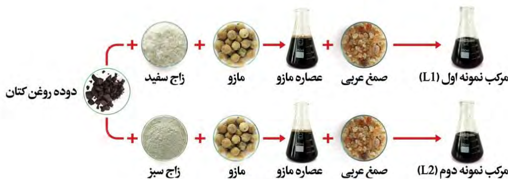
تصویر ۷: دستورالعمل تصویری ساخت نمونه‌ها (نگارندگان)
