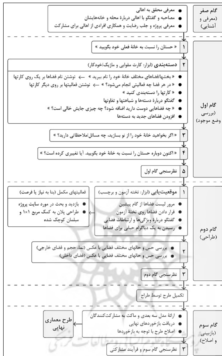
شکل ۲. فرآیند طراحی مشارکتی مسکن، حاصل ترکیب فرآیند و روش‌های یافته شده در مرور سیستماتیک
