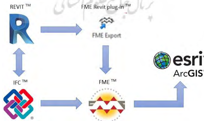
شکل ۴. فلوچارت 3D-GIS و BIM ارائه شده در (ژائو و همکاران، ۲۰۲۲)
