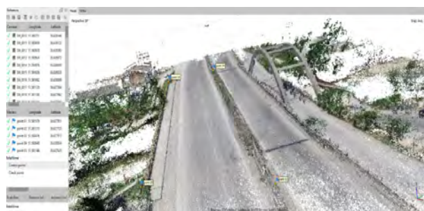
نگاره ۱۱: ابرنقاط تشکیل شده پس از پردازش اولیه
