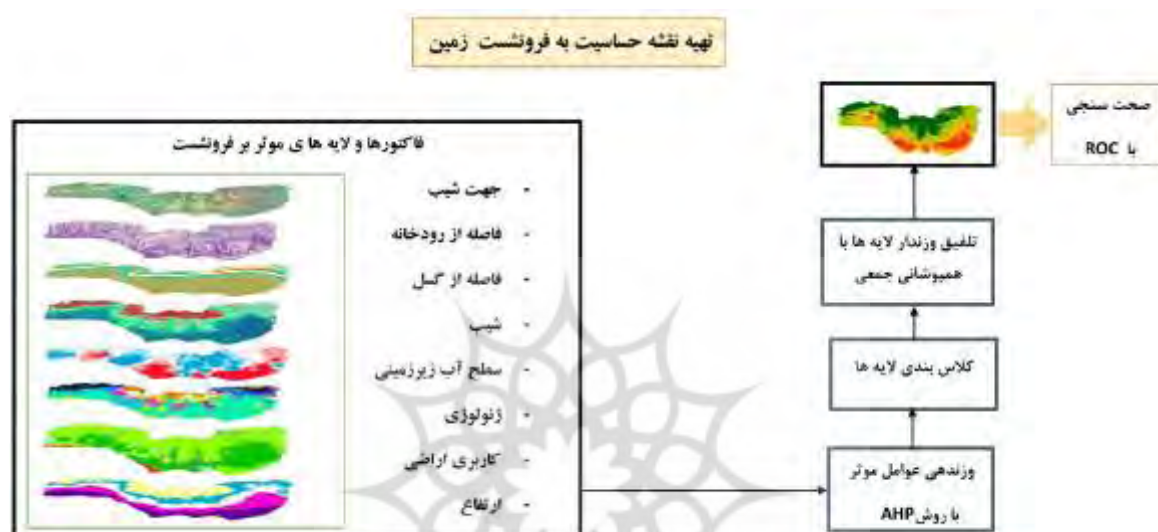
شکل (۲). مراحل کلی به کار رفته برای مدل‌سازی حساسیت به فرونشست
