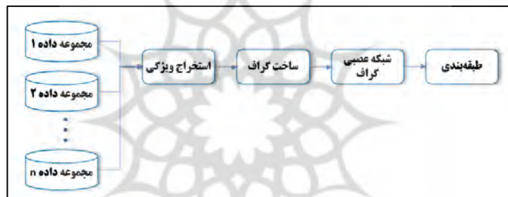
شکل ۲- مدل شبکه های عصبی گراف در تشخیص اخبار جعلی (Lakzaei, et.al, 2024:3)
