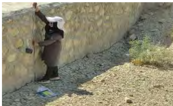
شکل (۳): اندازه‌گیری ارتفاع رسوبات ته‌نشین شده پشت بند اصلاحی
