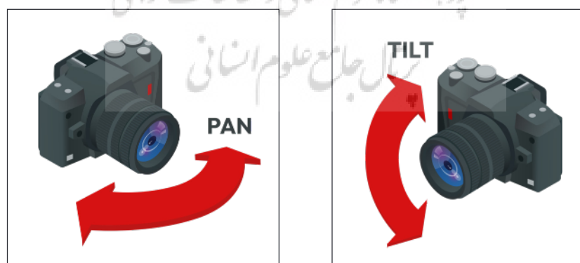
شکل ۷. نمایش حرکت تیلت و پن، در این دو حرکت محور حسگر ثابت است و فقط سر لنز به صورت منحنی در جهت افقی یا عمودی حرکت می‌کند (ترسیم: فریبا معصومی‌پور).
