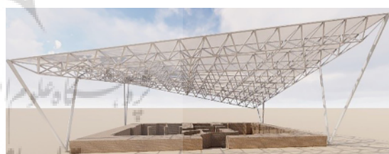
شکل ۹. طرح پوشش سازه فضاکار و نقشه‌های فاز یک در قالب نقشه‌های دوبعدی و تصاویر سه‌بعدی در طرح پیشنهادی اول. Figure 9. Space structure covering design and Phase 1 maps in the form of two-dimensional maps and three-dimensional images in the first proposed design.
