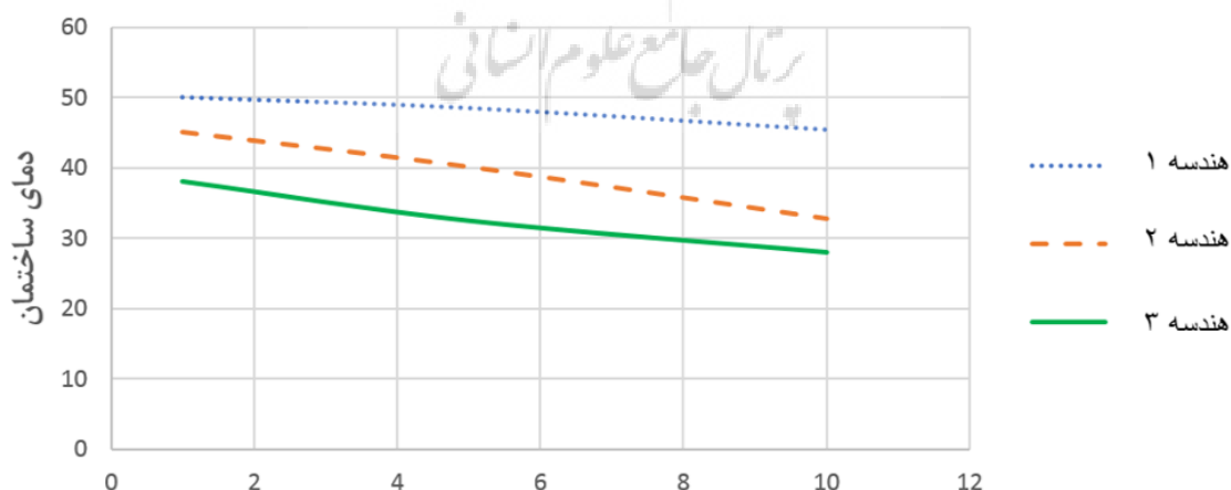
شکل ۲۵- تغییر دمای داخل ساختمان نسبت به تغییر سرعت جریان هوا در پاکت دوپوسته.
