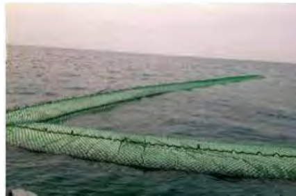
شکل ۸- لوله‌ی پلاستیکی (مشک ماری) حمل و نقل دریایی سوخت، صدمه و نشت این مشک می‌تواند یک آلودگی عظیم را ایجاد کند. (منبع: نویسندگان، ۱۴۰۲)
