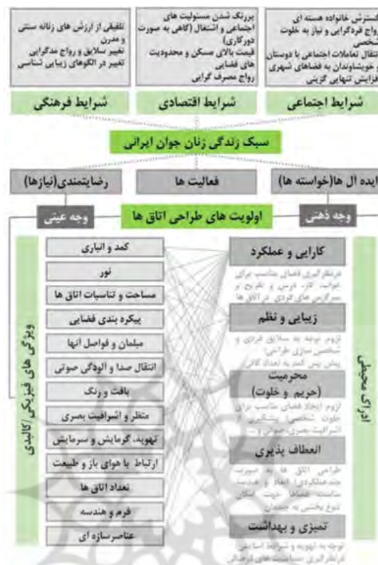
نمودار ۴. مدل مفهومی تبیین‌کننده کیفیت‌های طراحی اتاق‌های واحدهای مسکونی آپارتمانی مرتبط با سبک زندگی زنان
