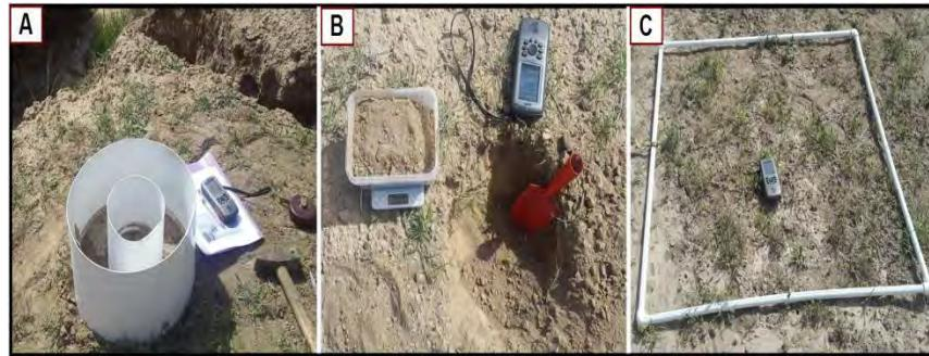
شکل (۵): A: اندازه‌گیری نفوذپذیری توسط استوانه‌های مضاعف؛ B: برداشت نمونه خاک از بیشانی آبکند جهت بررسی ویژگی‌های فیزیکی و شیمیایی خاک؛ C: پلات گذاری جهت اندازه‌گیری درصد سنگریزه، خاک لخت، پوشش گیاهی و لاشبرگ (مأخذ: نگارندگان، ۱۳۹۶).
