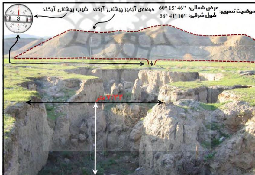
شکل (۴) نمایی شماتیک از چگونگی اندازه‌گیری شب، عرض و حوضه‌ی آبخیز پیشانی آبکند
