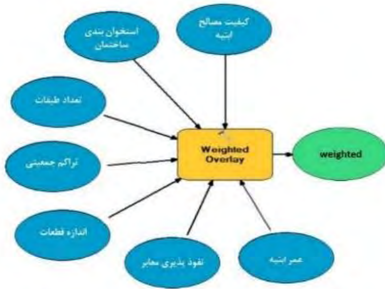
شکل ۵. مدل طراحی شده جهت تولید لایه خروجی با استفاده از ابزار Model Builder
