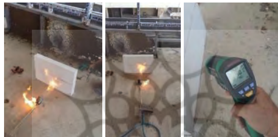
تصویر ۷- آزمایش میدانی نمای پوسته‌ای به‌عنوان عایق حرارتی و برودتی
