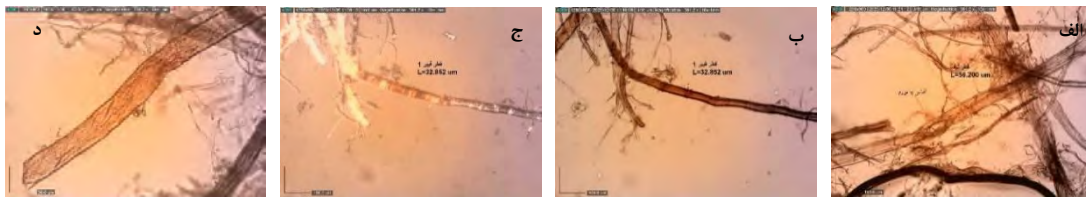
شکل ۱۷: الیاف پوستی شاهدانه، کتان و پنبه در خمیر کاغذ ترمه خانباغ ۳۶ (قرن ۱۱ ه.ق): الف) ضخامت‌های مختلف در راستای لیف، آماس و حفره لومن پهن در الیاف قطور، ب) الیاف با راستای مستقیم و بندهای برجسته، ج) بندهای مشخص در نور پلاریزان و د) الیاف پنبه
