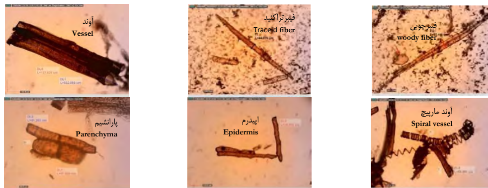
شکل ۷: الیاف چوبی کف با میکروسکوپ نوری ۱۰۰X و ۲۰۰X Fig. 7: Kenaf woody fibers with light microscopic at x100 and x200 magnification
