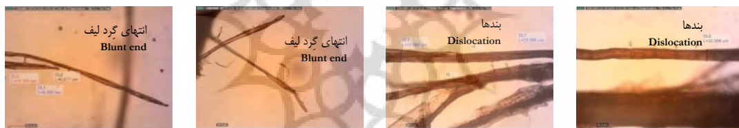
شکل ۵: الیاف پوستی شاهدانه با میکروسکوپ نوری ۲۰۰X Fig. 5: Bast fibers of hemp with light microscopic at x200 magnification
