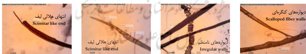
شکل ۸: الیاف پوستی کف با میکروسکوپ نوری ۲۰۰X Fig. 8: Bast fibers of kenaf with light microscopic x200 magnification
