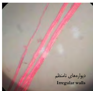
شکل ۸: الیاف پوستی کف با میکروسکوپ نوری ۲۰۰X Fig. 8: Bast fibers of kenaf with light microscopic x200 magnification
