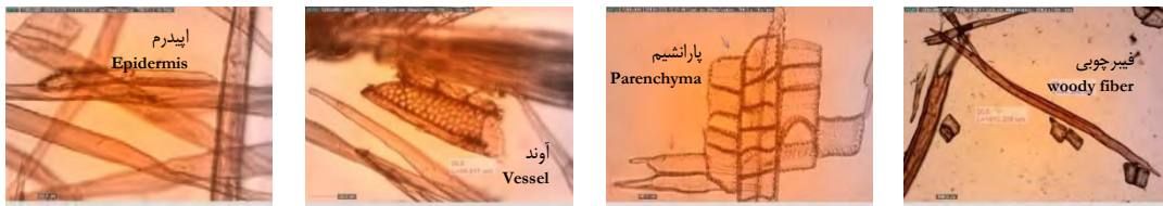
شکل ۴: الیاف چوبی شاهدانه با میکروسکوپ نوری ۲۰۰X Fig. 4: Woody fibers of hemp with light microscopic at x200 magnification
