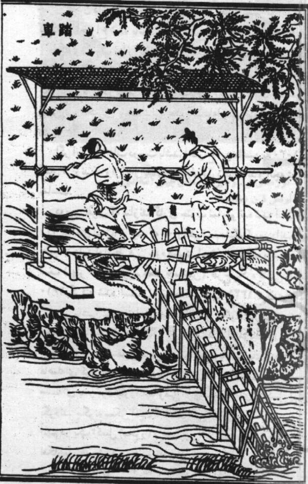
بالا بردن آب برای آبیاری در قرن هفدهم در چین، با استفاده از پمپ زنجیره‌ای پدال دار دو نفره.
