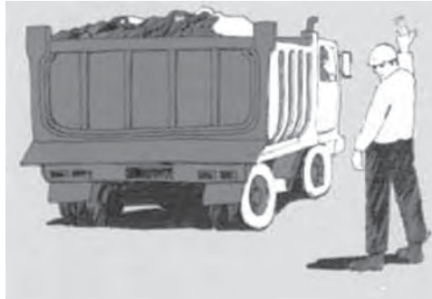
شکل ۳- هنگام استفاده از دنده عقب از فردی را به عنوان راهنما قرار دهید.
