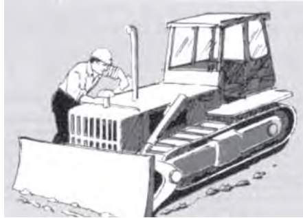
شکل ۱- قبل از شروع به کار با ماشین آلات در معدن، قسمت های مهم را بازرسی نمایید.
